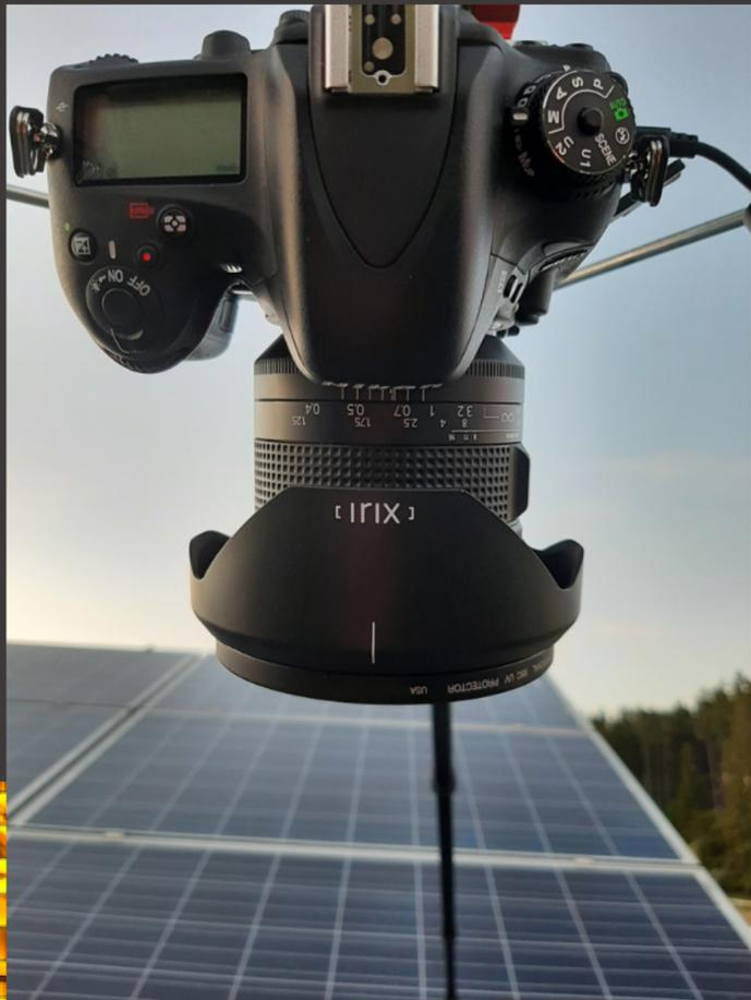
Imagerie par électroluminescence de modules photovoltaïques :
