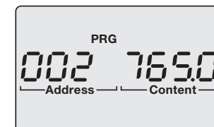
Anzeigenbeispiel 1: Die Primärspannung jedes Spannungswandlers an den 4 Spannungsmesseingängen beträgt 765 V.
