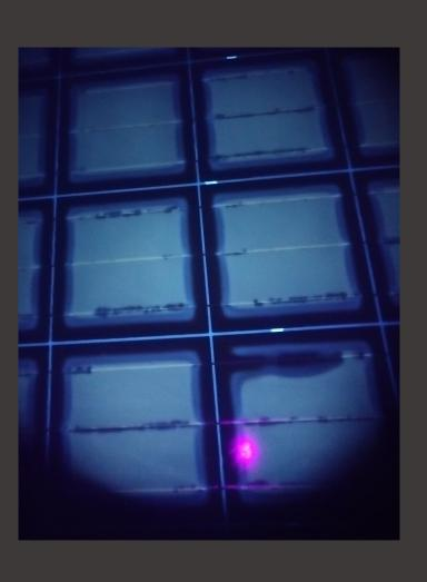
Visualisez rapidement les fissures et les mirco cracks: Pas besoin de déconnecter les câbles du module
